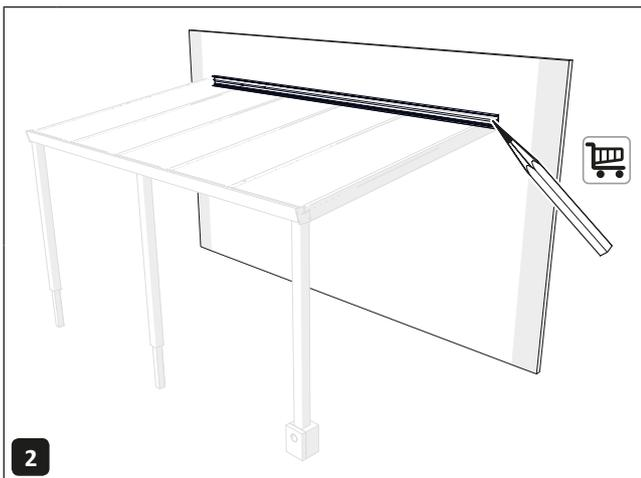
Bestimmen Sie den Montageort des Wandprofils und kennzeichnen Sie diesen. Berechnen Sie die Höhe mithilfe der Rechentabellen in Anhang 1 und 2 auf Seite 28 bis 31 in dieser Anleitung.
