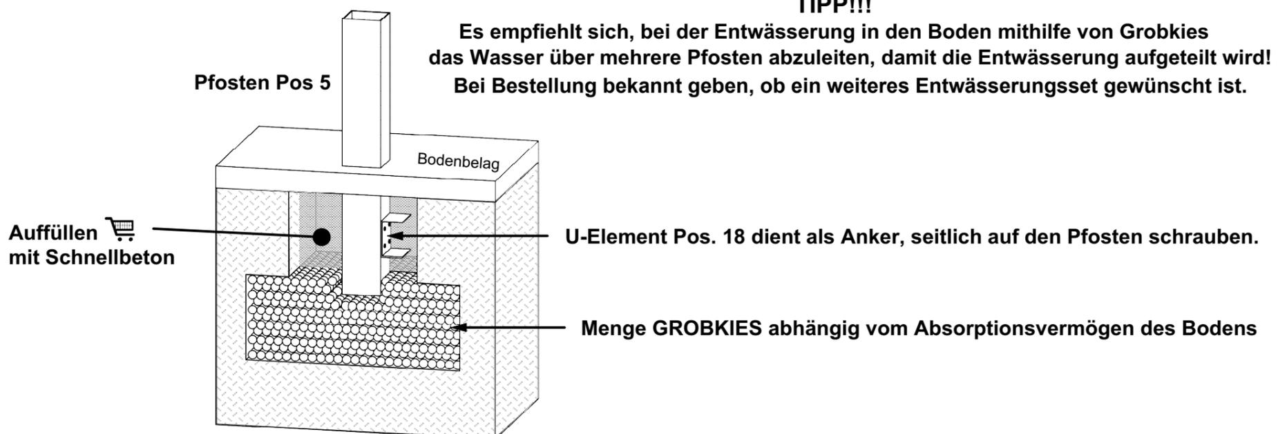
Variante 03: **Bodenanker aus Kunststoff mit Regenwasserableitung**
