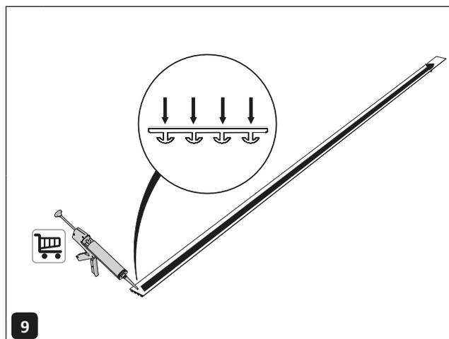
9 Tragen Sie Montagekitt auf die flache Rückseite der Unterschiene auf.
