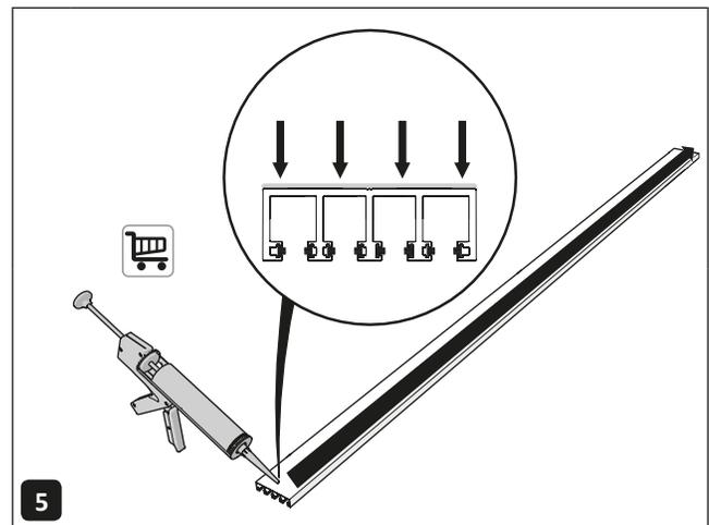
Tragen Sie Montagekitt auf die flache Rückseite der Pfostenprofile auf.
