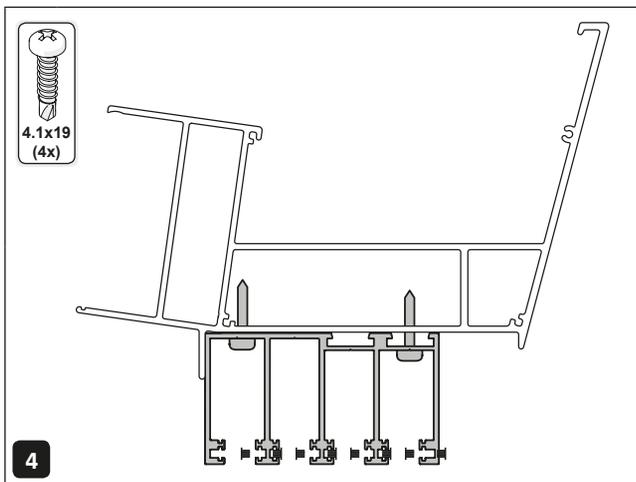
Für Montage unter einer GIGA-Rinne: Befestigen Sie die Oberschiene wie oben abgebildet. Das können Sie auch tun, wenn Sie die Schiene unter einer baulichen Konstruktion oder Überdachung aus Holz montieren.
