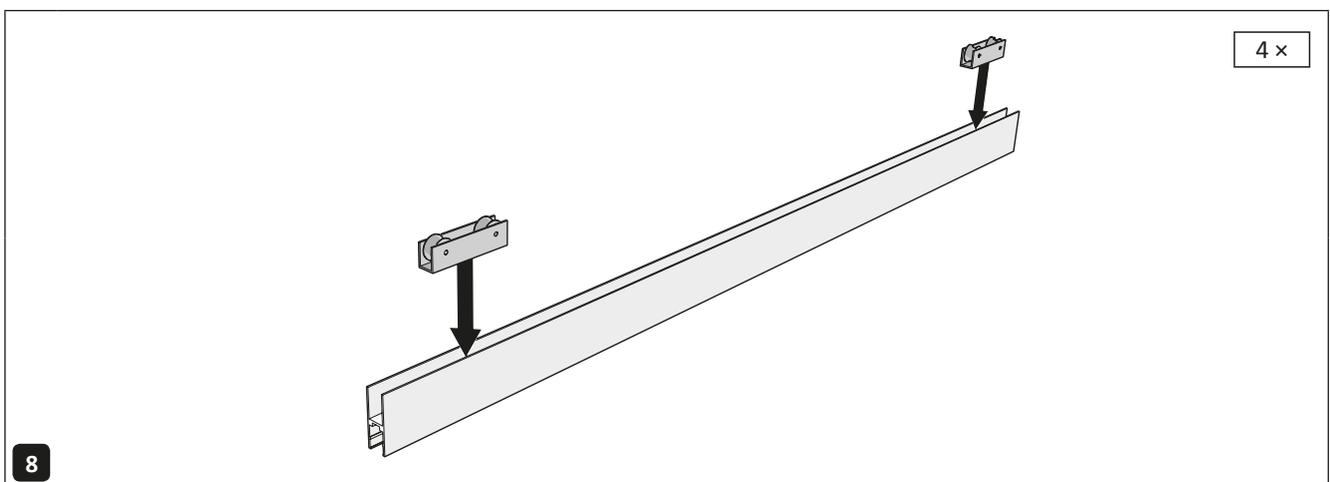
Schieben Sie die Laufrollen in alle Glasträger. Verwenden Sie zwei Laufrollen pro Glasträger. Befestigungselemente sind nicht notwendig, weil die Laufrollen von selbst im Glasträger halten.
