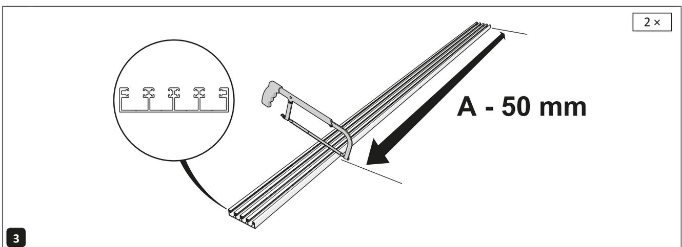
Schneiden Sie die zwei Pfostenprofile auf Länge A (Höhe) – 50 mm zu.
