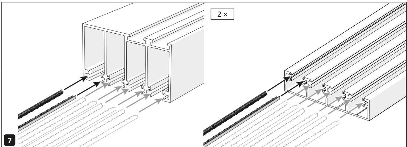
Schieben Sie die Bürsten in die Oberschiene und in die Pfostenprofile.
