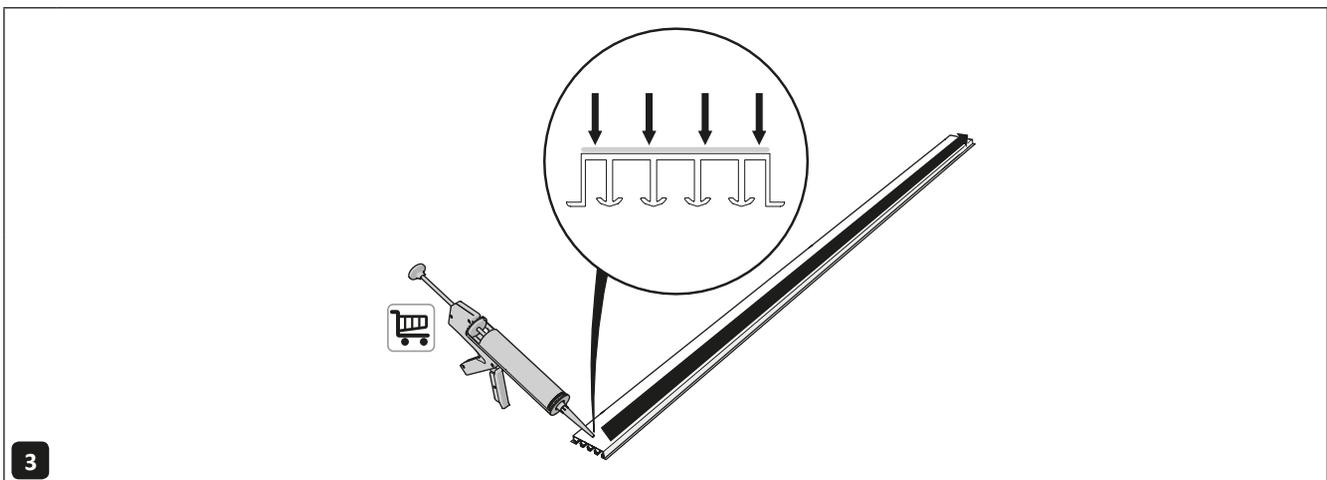
3 Tragen Sie Kitt auf die flache Unterseite der Unterschiene auf.
