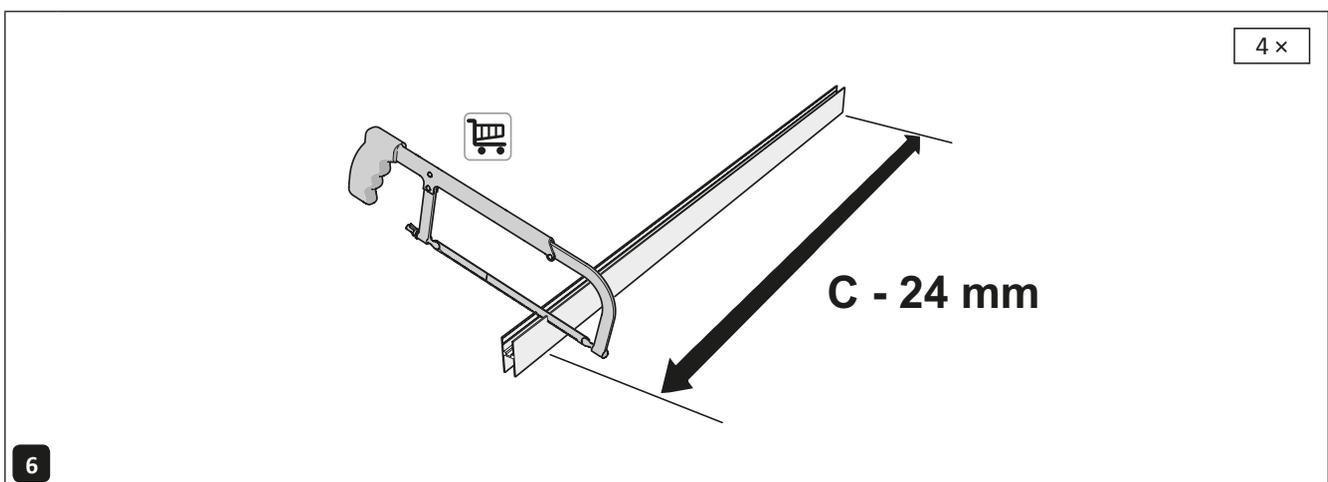
Schneiden Sie alle Glasträger auf Länge C (Glasbreite) – 24 mm zu.
