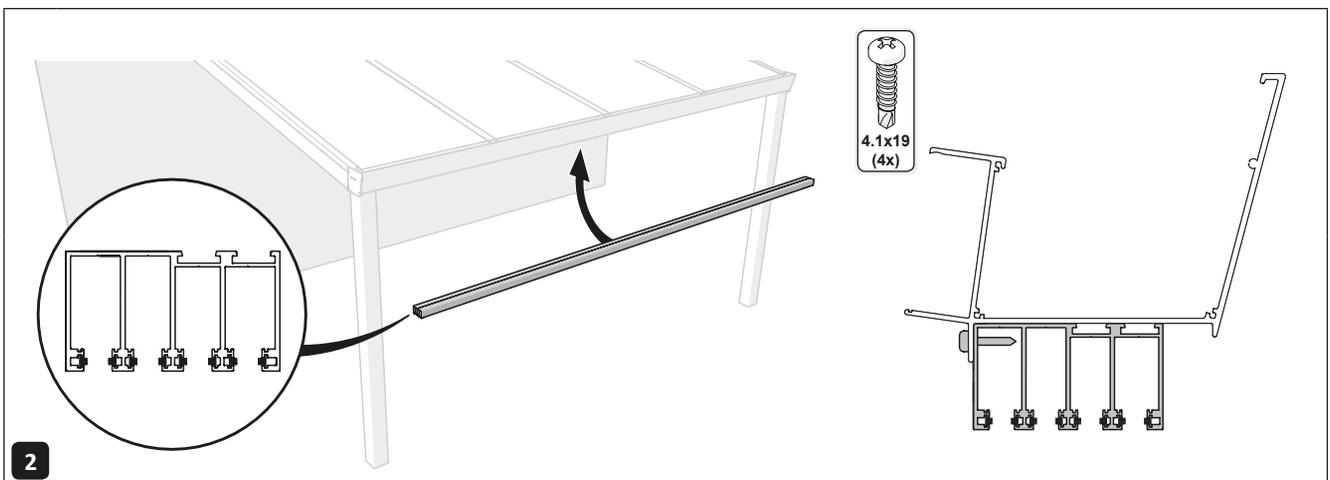
2 Bringen Sie die Oberschiene in Position und fixieren Sie die Schiene von Baustützen (3). **Achtung!** Bei Montage unter einer Veranda-Rinne: Positionieren Sie die Oberschiene an dem Anbaurand der Rinne und befestigen Sie die Oberschiene mit Schrauben. **Achtung!** Befestigen Sie die Schrauben auf keinen Fall im Boden der Rinne!
