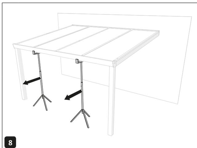
8 Entfernen Sie die Baustütze, wenn die Oberschiene befestigt ist und sie durch die Pfostenprofile abgestützt wird.
