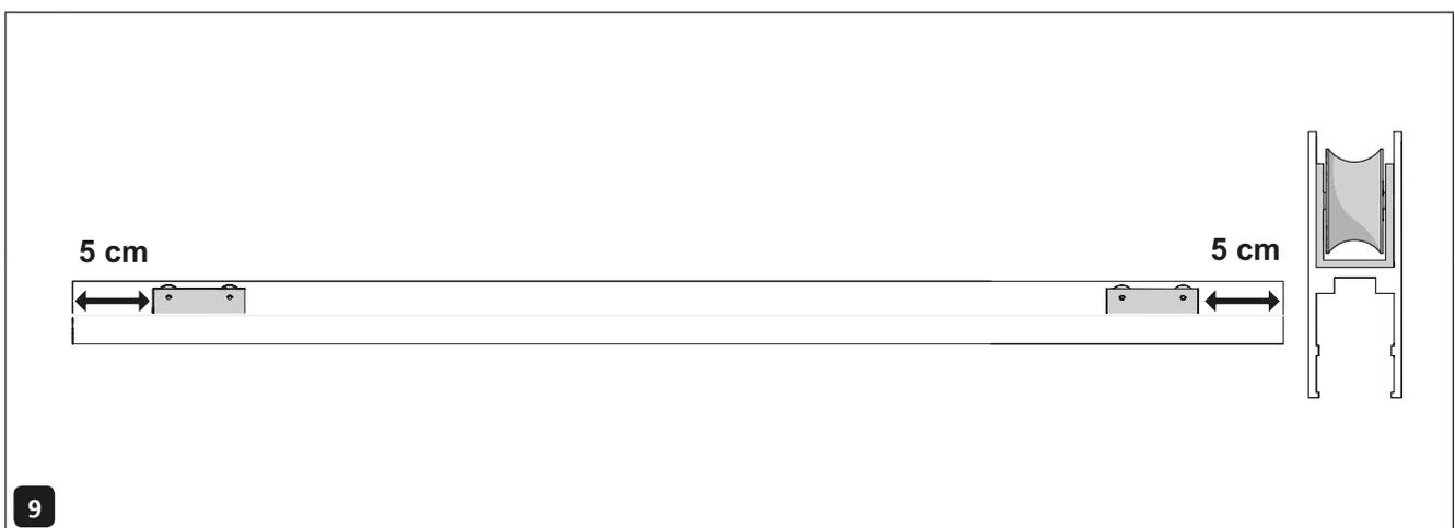
Positionieren Sie die Laufrollen in einem Abstand von 5 cm vom Ende der Glasträger.
