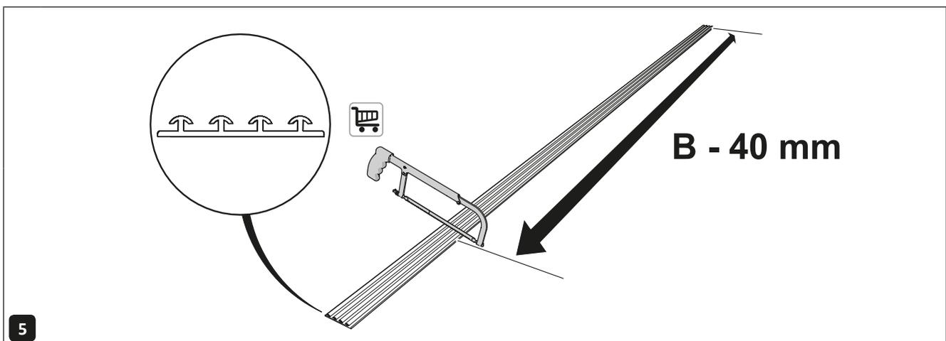
Schneiden Sie die Unterschiene auf Länge B (Breite) – 40 mm zu.
