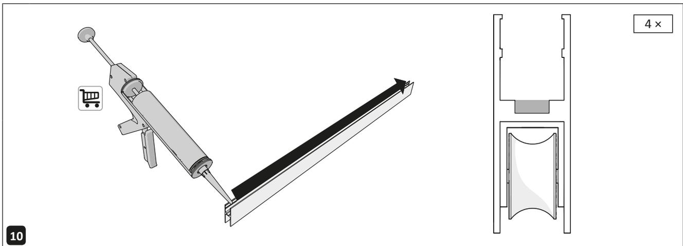
10 Tragen Sie eine dünne Schicht Kitt in allen Glasträgern (A) auf.
