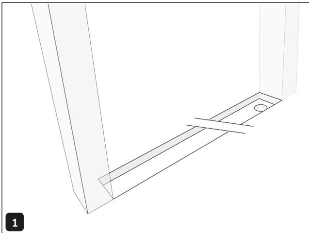
1 Sorgen Sie für eine Aussparung zwischen den Pfostenprofilen und für ein Loch für den Wasserabfluss.
