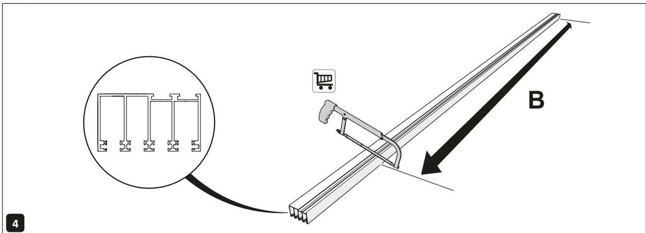
Schneiden Sie die Oberschiene auf Länge B (Breite) zu.
