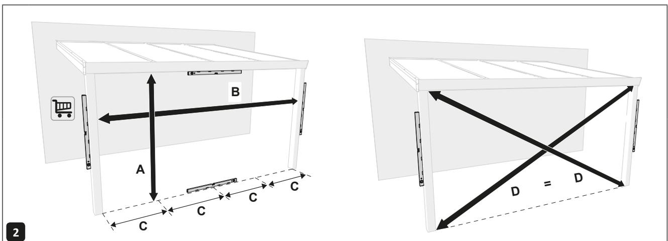
Messen Sie die Längen A (Höhe), B (Breite), C (Glasbreite) und D (diagonal) ab.
