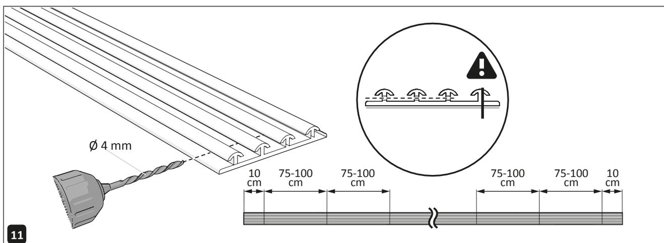
11 Bohren Sie waagrecht  $\varnothing 4$  mm Wasserabflusslöcher in die äußeren drei Unterschinen. Bohren Sie die ersten Löcher 10 cm vom Ende entfernt. Verteilen Sie die Löcher danach im Abstand von 75 bis 100 cm voneinander. Achtung! Bohren Sie nicht durch die innerste Schiene, sonst läuft das Wasser nach innen.
