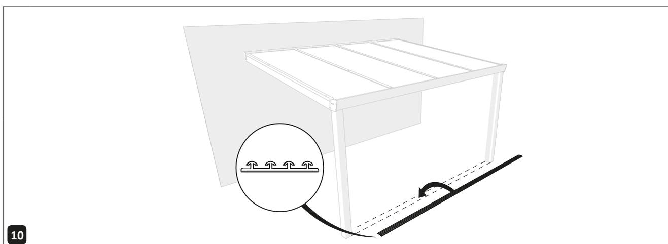
10 Bringen Sie die Unterschiene in Position. Achtung! Sorgen Sie dafür, dass der Untergrund genau waagrecht ist.
