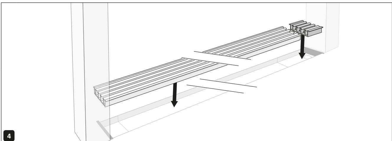
4 Setzen Sie die Unterschiene in die Aussparung ein und setzen Sie das kurze Ablaufstück auf die Abflussöffnung.
