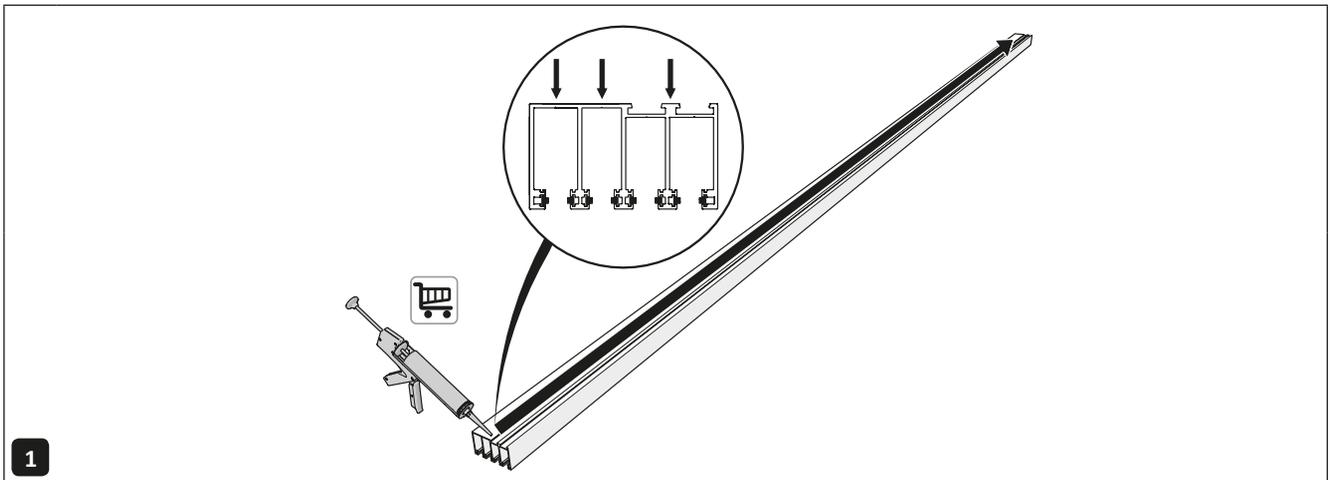
1 Tragen Sie Montagekitt auf die flache Oberseite der Oberschiene auf.
