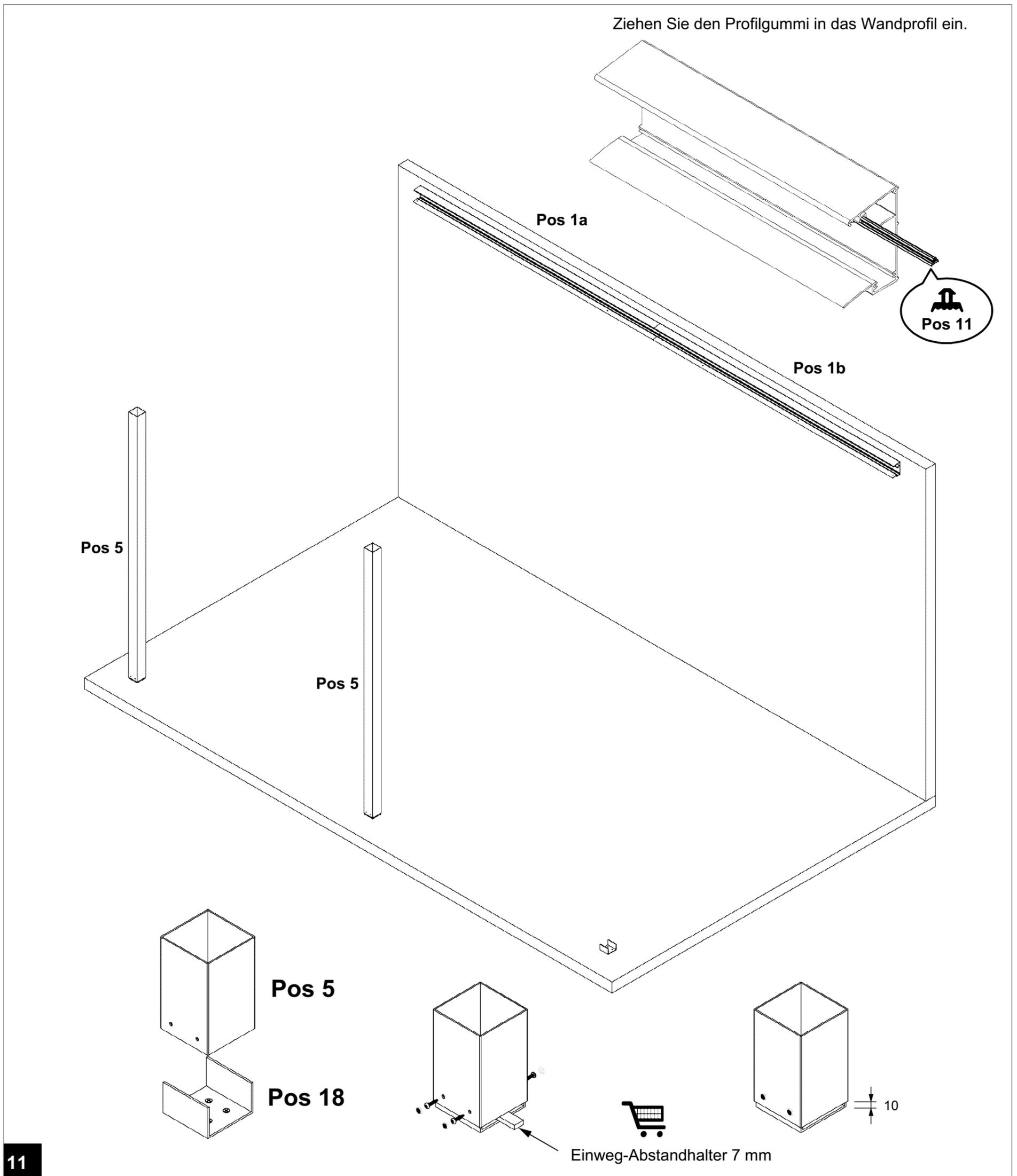
Schieben Sie die ersten zwei Pfosten über die U-Elemente. Halten Sie 10 mm Abstand von den Pfosten zum Boden, um den Wasserabfluss zu ermöglichen.
